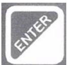
Im STOP- Modus und im RUN- Modus wird durch Drücken dieser Taste die gerade vom Inverter angenommene Frequenz (angewählt über die Pfeil- Taste) nullspannungssicher gespeichert.
