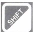
Wird diese Taste während der Betätigung einer der Pfeil- Tasten gedrückt, wird die Änderungsfrequenz der Display- Anzeige erhöht.
